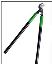
Schwere Durchforstungs-Schere, vorbeischnidend, aus Stahl geschmiedet, Schneidklinge im Rücken rundgeschliffen, Länge total: 75 cm.
