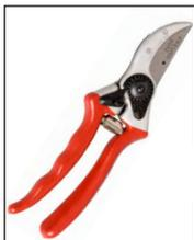
Gartenschere, aus Aluminium geschmiedet, vorbeischneidend, Klinge und Haken aus hochwertigem Carbon-Stahl, auswechselbar, Drahtabschneider, Zahnsegment-Muttersicherung, Gummianschlag, mit Werkzeughalter, Länge total: 21 cm.
